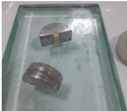
Figura 6 - Amostra após polimerização, sendo removida da matriz.
