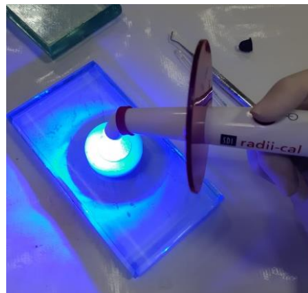
Figura 5 - Polimerização da amostra inserida na matriz metálica.
