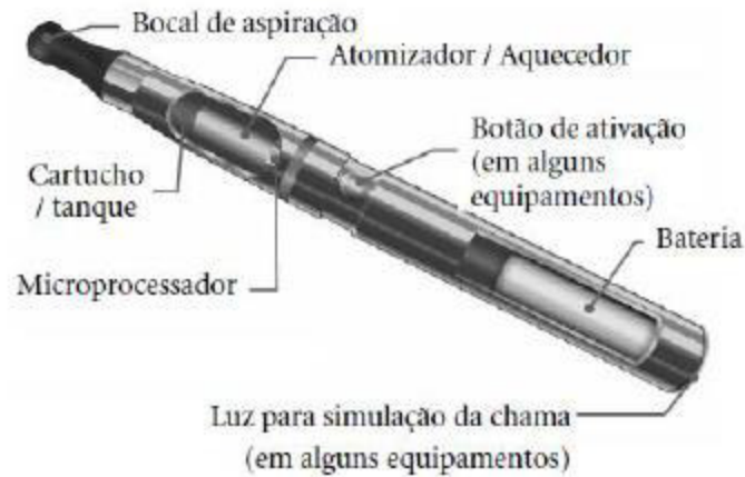
Figura 1: Composição estrutural de um dispositivo eletrônico para fumar.
