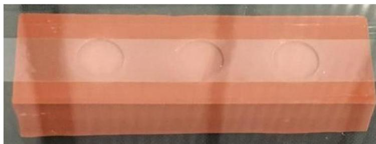
**Fig. 2- Modelo para confecção dos corpos de prova (1mm de espessura x 10 mm de diâmetro).**
