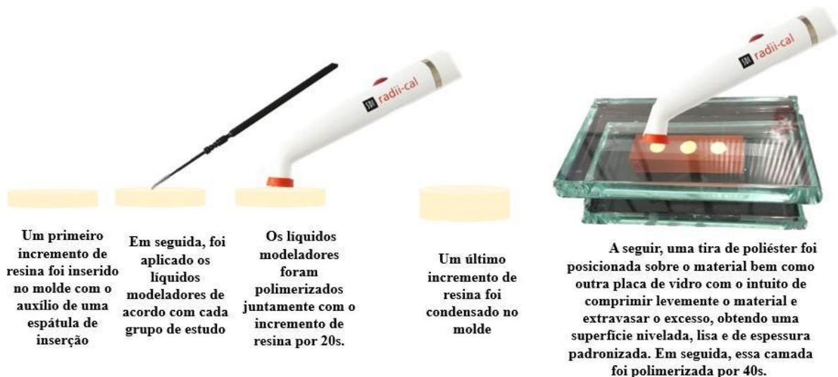
**Fig. 5- Esquema representativo da confecção dos corpos de prova do Grupo 2, 3, 4 e 5 (G1, G2, G3, G4 e G5).**
