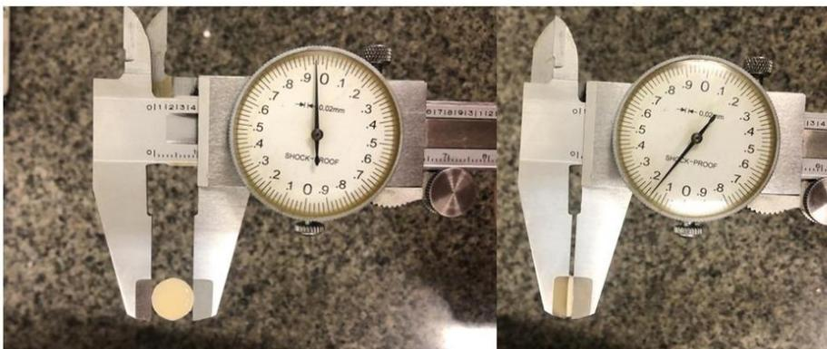
**Fig. 7- Quatro aferições equidistantes foram realizadas através de um paquímetro, para conferência da espessura e largura dos corpos de prova. Após obtenção das medidas foi calculada uma média para mensuração do volume do corpo de prova (diâmetro 10mm x 1mm de espessura).**
