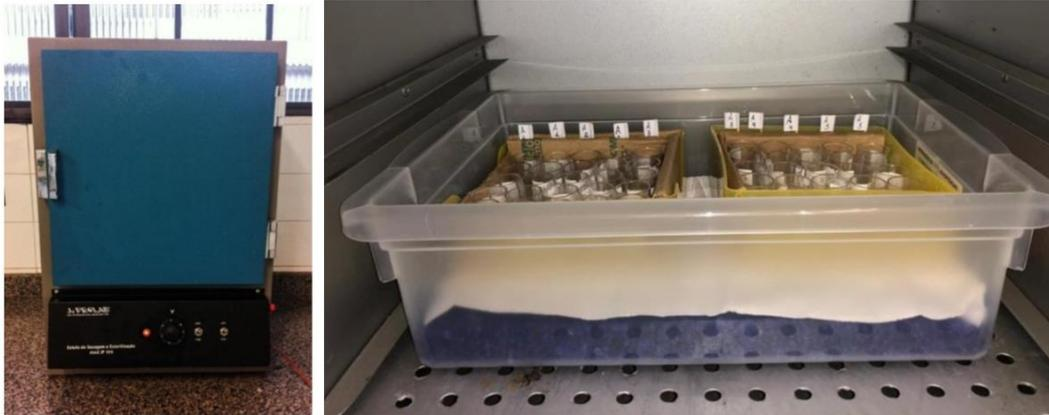
**Fig. 9- Os potes de acrílico ficaram com as tampas abertas, para remoção da água livre. Esse dessecador foi levado ao interior de uma estufa bacteriológica (ECB2, Biodont, Odontobrás, Ribeirão Preto, SP, Brasil) com temperatura controlada em  $37\pm 1^{\circ}\text{C}$ .**
