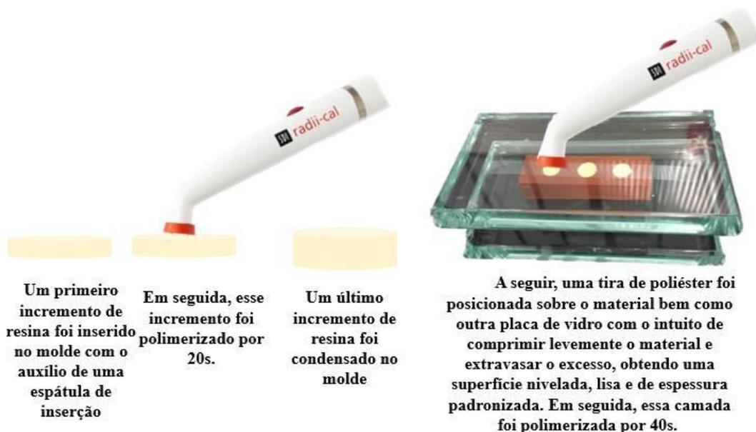
Fig. 3- Esquema representativo da confecção dos corpos de prova do Grupo 1 (G1).
