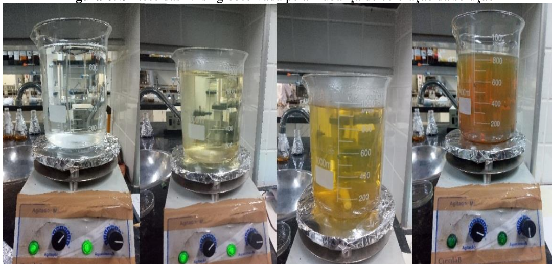
Figura 6. Síntese das NPsAg observada pela mudança de coloração da solução
