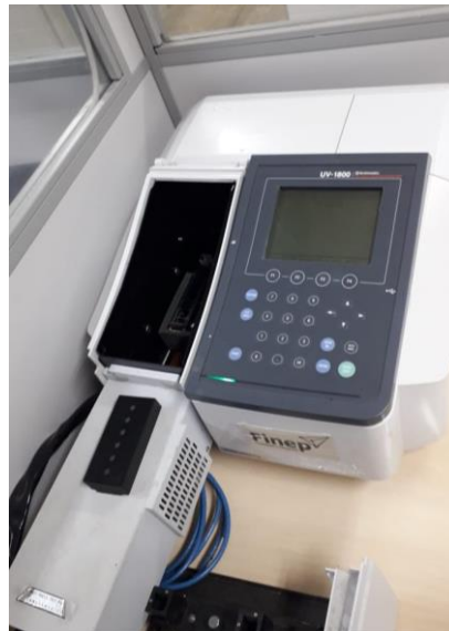
Figura 5. Espectrofotômetro UV-Vis utilizado na caracterização das AgNPs
