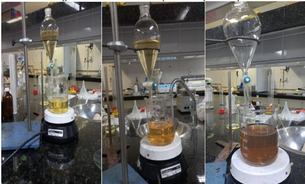
Figura 7. Processo de estabilização das nanopartículas prata
