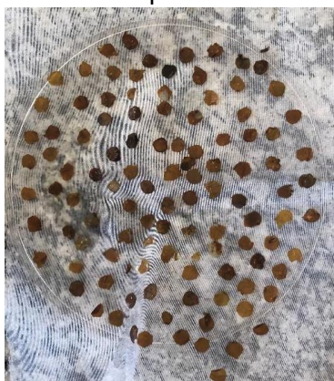
Figura 6 – Discos de membranas de celulose bacteriana impregnadas com nanopartículas de prata produzidas no experimento e usados no teste de sensibilidade
