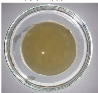
Figura 1 – Membrana de celulose bacteriana após sua coleta e lavagem em água deionizada
