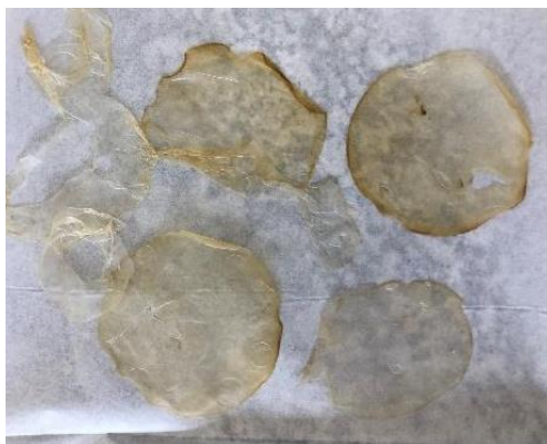
Figura 3 – Membranas de celulose bacteriana após os processos de purificação, descelularização e secagem.
