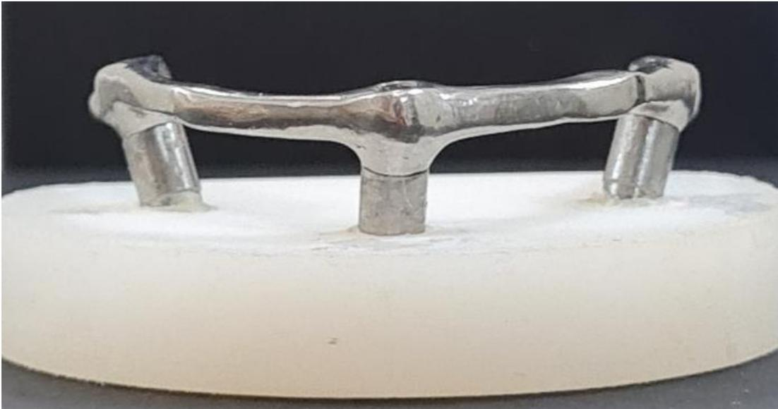
Figura 2. Modelo-mestre com a estrutura metálica em NiCr.
